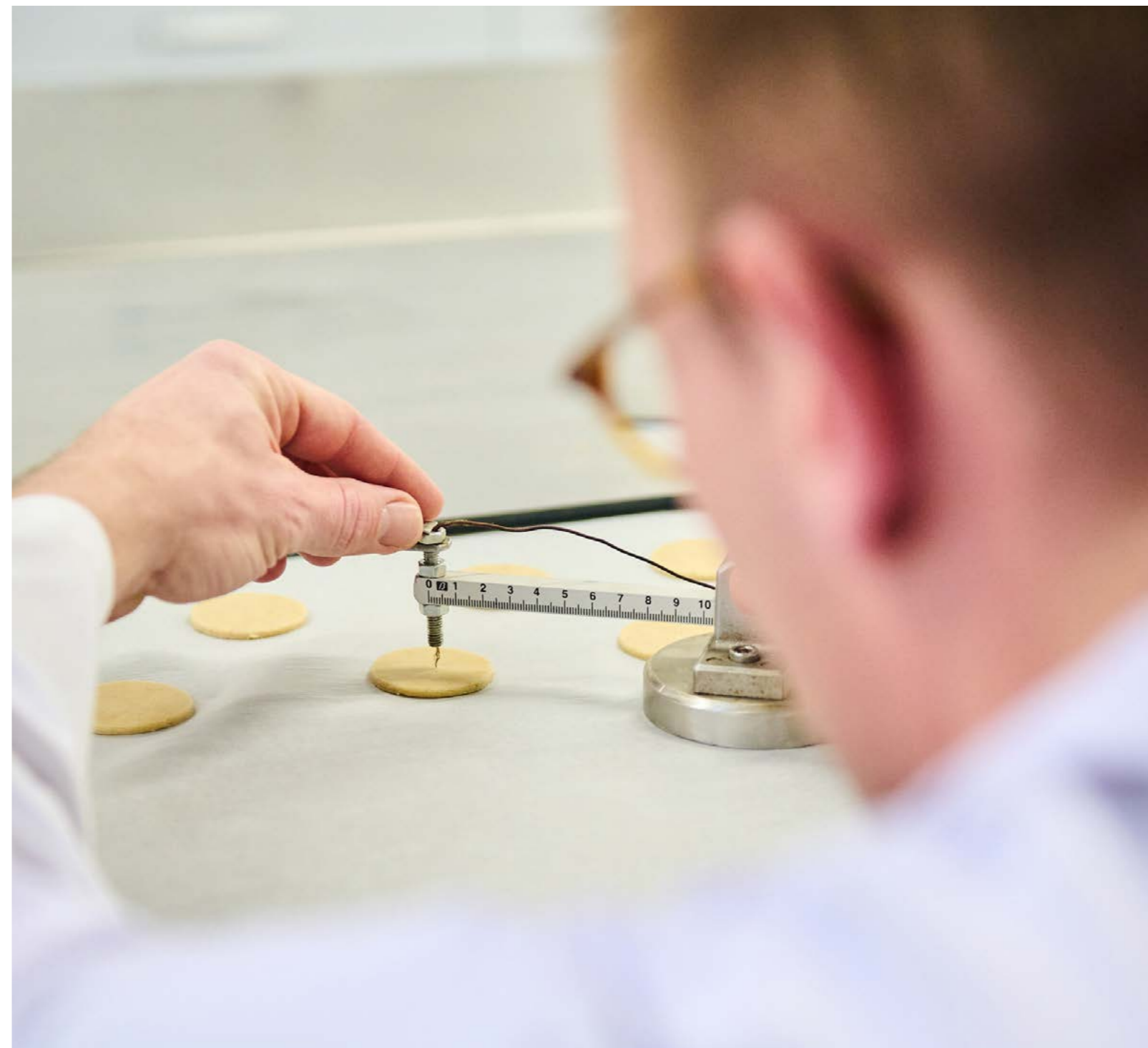
R&D collega plaatst een sensor om de temperatuur van het deeg te kunnen meten
